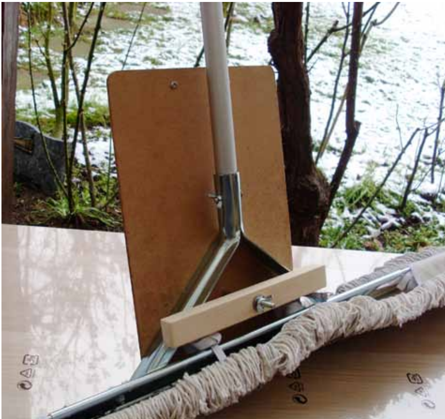
Bild 1: Montage des Klemmbretts auf den Volley-Mopp
